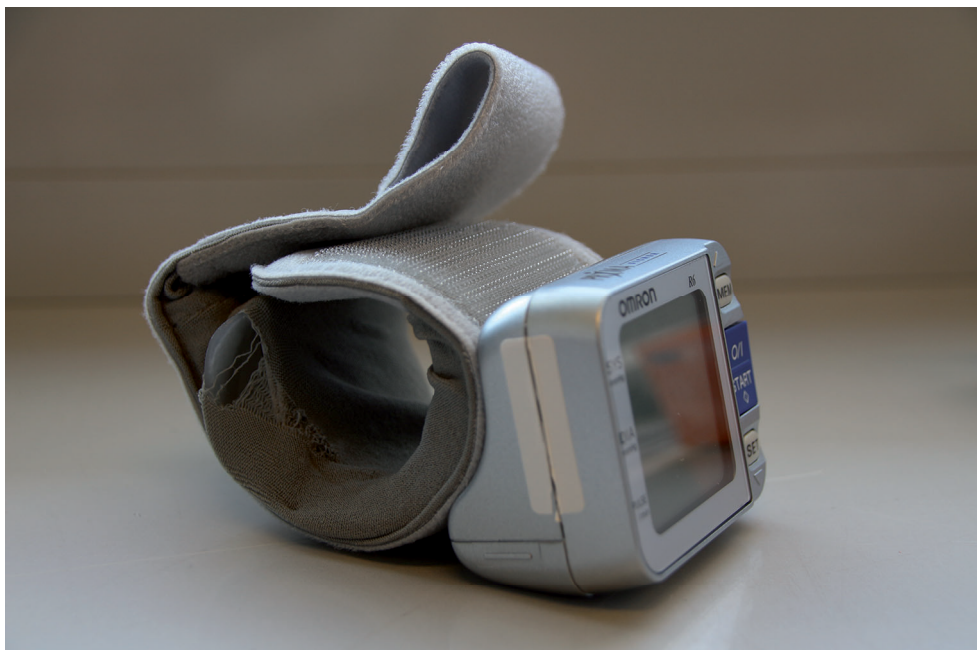
Abb. 4.1-1 Das dargestellte Blutdruckmessgerät ist im Bereich der Manschette beschädigt. Zwar wird dadurch die Funktion wahrscheinlich noch nicht beeinträchtigt, doch kann dies ohne weitere technische Prüfung nicht beurteilt werden. Das Gerät ist daher nicht anzuwenden und einer Instandhaltung zuzuführen. Zudem fällt bei der visuellen Kontrolle auf, dass ein Siegel (weißer Aufkleber) beschädigt wurde. Der Anwender weiß also nicht, ob ggf. am Gerät Manipulationen oder (sachgemäße?) Reparaturen durchgeführt wurden. Eine Anwendung ohne weitere Kontrolle ist nicht zu empfehlen.
